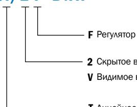
**2** Скрытое винтовое крепление**V** Видимое винтовое крепление**T** Линейное исполнение**6** Тип решетки AR-6, 7, 8, 9, 13, 14, JR-3, 4
